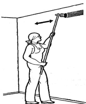
огрунтовочный состав на половину длины цайга (рабочей части). Прикладывая и слегка прижимая цайг к стенке ведра, плавным движением руки вверх с небольшим поворотом отжимает избыток огрунтовочного состава с кисти в ведро. Затем маляр прикладывает цайг к стене и плавным движением руки в горизонтальном направлении делает отводку верхней границы панели стены. Кисть при этом постоянно наклонена в направлении ее движения под углом  $70^\circ$  к поверхности стены.
