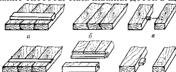
Рис 2.Способы соединения досок в щиты.
