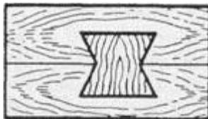
Рис. 7. Укрепления соединений шипом «ласточкин хвост»
