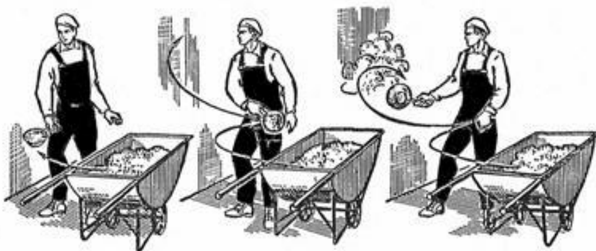
Рис. 92. Приемы нанесения раствора отделочным ковшом
